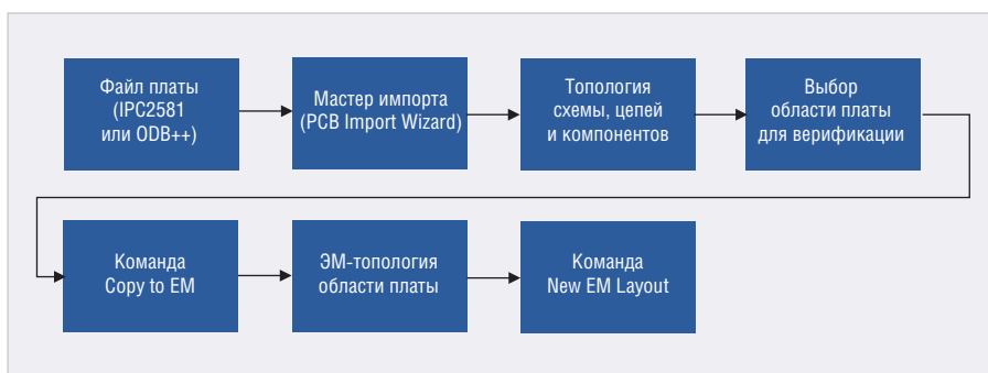
Рис. 5. Алгоритм ЭМ-верификации печатных плат, импортированных из САПР сторонних разработчиков
